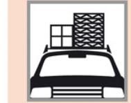
Si sobrecargamos el vehículo, se produce un deterioro excesivo de los neumáticos, así como un incremento evidente del consumo de combustible.
