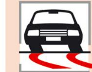
Una velocidad excesiva al tomar las curvas produce una torsión elevada de sus neumáticos y por tanto un desgaste excesivo.
