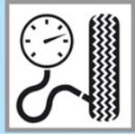
Compruebe cada quince días, en frío, que la presión sea la indicada por el fabricante. El exceso provoca un menor contacto y adherencia con el firme. La presión baja puede producir reventón, acorta su vida útil y aumenta el consumo de gasolina.
