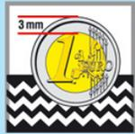
La profundidad del grabado no debe ser inferior a 3 mm, compruébelo fácilmente introduciendo un euro verticalmente en el dibujo, si llega a la parte dorada, la profundidad es correcta para conducir seguro.
