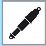
Un amortiguador en mal estado: dificulta el control del vehículo, aumenta la distancia de frenado y provoca un deterioro prematuro de los neumáticos.
