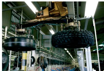
**6 Inspección final:** Eliminamos las rebabas, vientos y sobrantes de goma del proceso de vulcanizado. Finalmente, tras revisar que el neumático recauchutado no tiene ningún defecto, se pintan los talones y se da por finalizado el proceso enviándolo al almacén para su posterior distribución y uso.
