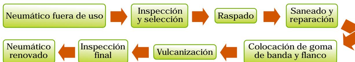
**1 Inspección de carcacas:** El objetivo de esta inspección es el de seleccionar carcacas para renovar que estén libres de defectos y daños irreparables que no puedan soportar otro ciclo de vida como neumático. La inspección de carcacas se divide a su vez en cuatro procesos:
