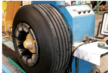
**5 Vulcanización en caliente:** Su elaboración es similar al de un neumático nuevo. Es un proceso de curación en molde de círculo cerrado. El molde está compuesto por un aro de aluminio segmentado en seis piezas, para marcar el dibujo de la banda de rodadura, junto a dos platos, uno para cada flanco, que marcarán los datos del costado.
