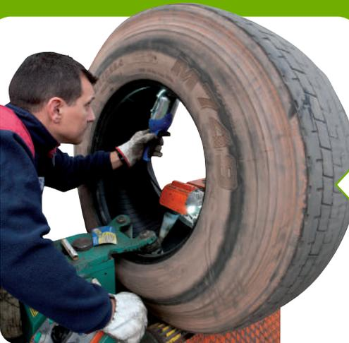
Se inspeccionan seleccionando los aptos para renovar, el 10% aproximadamente.
