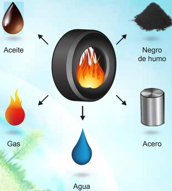
La pirólisis es la descomposición química de materia orgánica y todo tipo de materiales, excepto metales y vidrios, causada por el calentamiento a altas temperaturas en ausencia de oxígeno.
