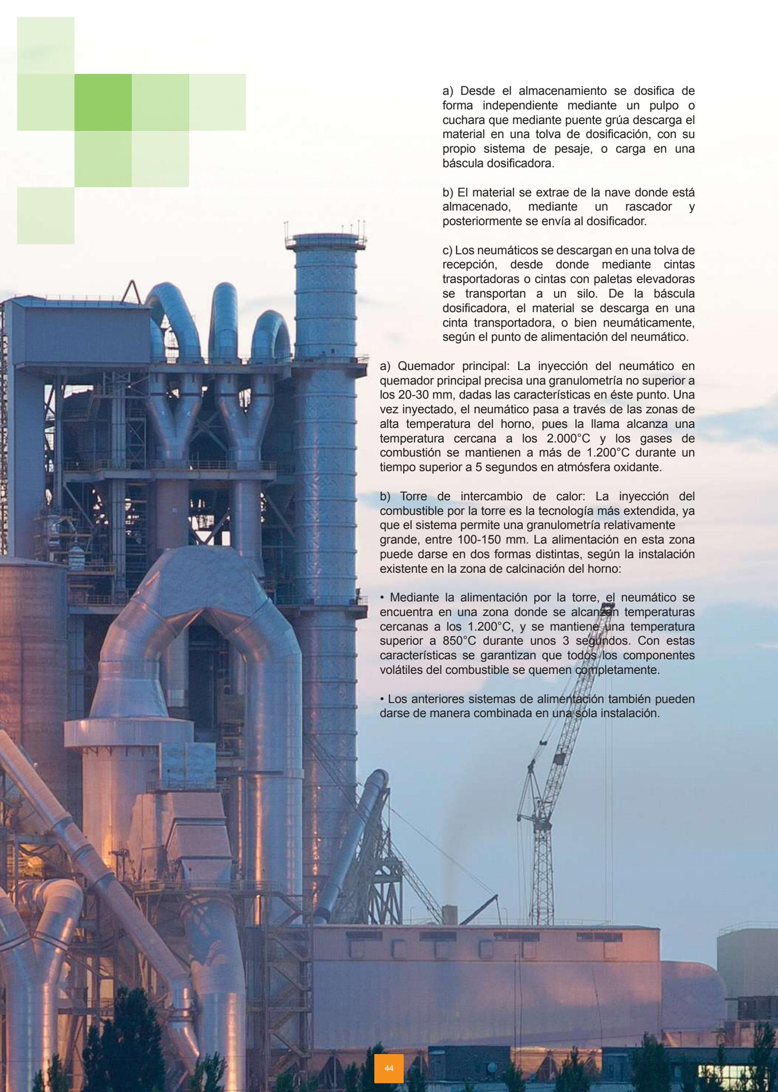
a) Desde el almacenamiento se dosifica de forma independiente mediante un pulpo o cuchara que mediante puente grúa descarga el material en una tolva de dosificación, con su propio sistema de pesaje, o carga en una báscula dosificadora.
